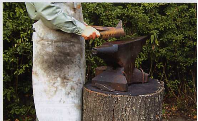
WICHTIGES STÜCK: Der Amboss darf beim Schlagtest nicht klirren.
