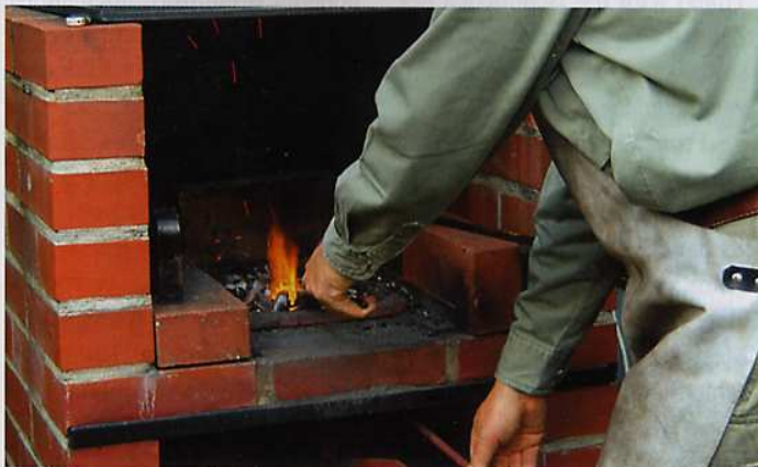
REGELWERK: Mit drei Hebeln lassen sich Schmiedesse und Luftzufuhr steuern.
